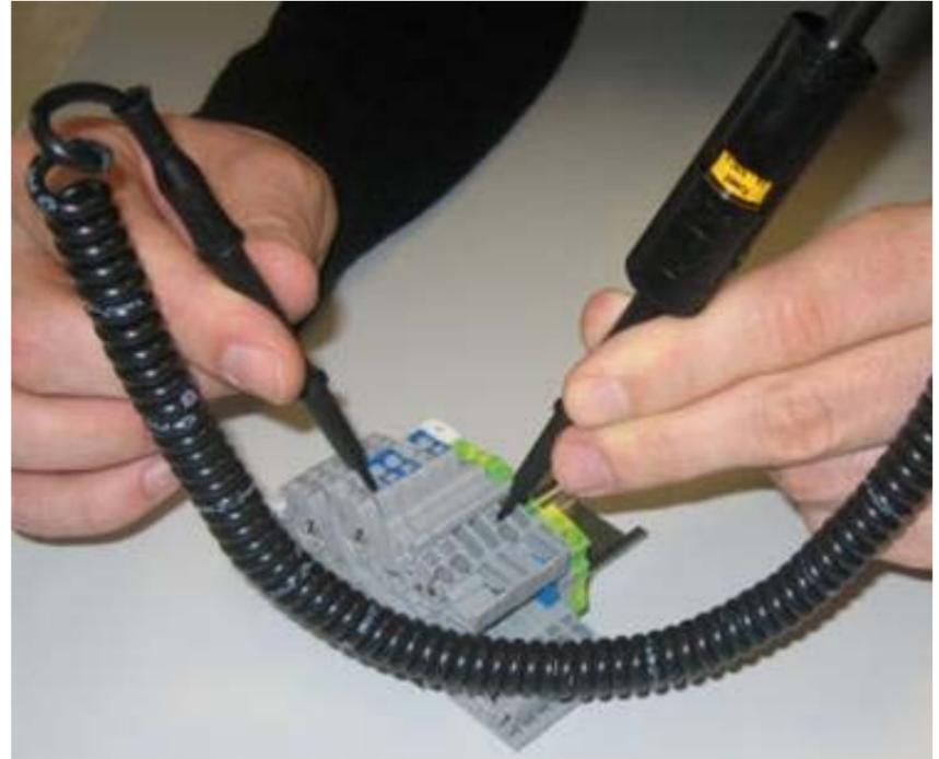
Ref : kitshunttest2 500 volts, catégorie 3 avec isolation renforcée, 2 A. et porte fusible.
